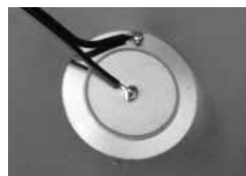
◀圧力を加えることで発電することができる圧電素子。児童が手で簡単に発電することができる。
